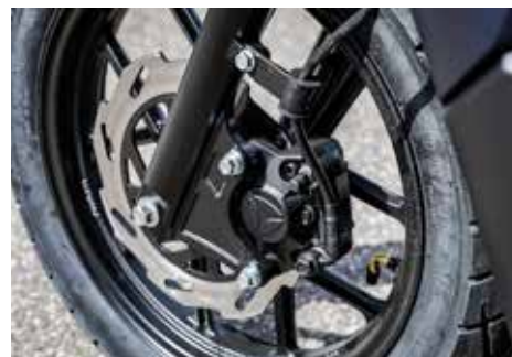
De Yadea heeft een gecombineerd remsysteem
